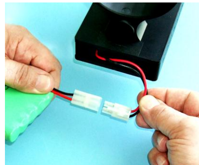
Presionar el gancho de seguridad para desbloquear el conector y desconectarlo
